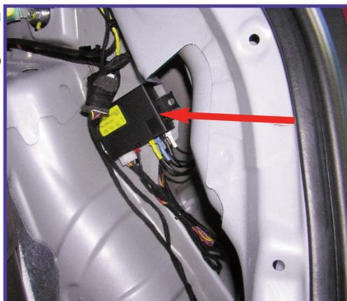
**SEGNALATORE ACUSTICO** : Fissare il segnalatore acustico (buzzer) sopra il supporto cintura di sicurezza sul fianco baule lato passeggero.
