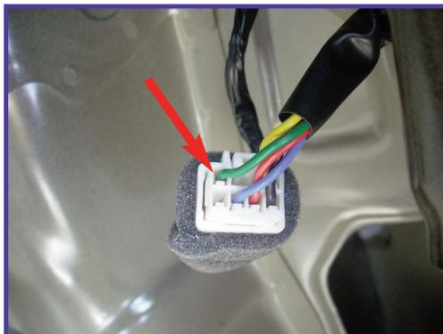
**NEGATIVO:** Per il collegamento elettrico individuare il filo NERO nel connettore da 6 poli del faro lato guida.
